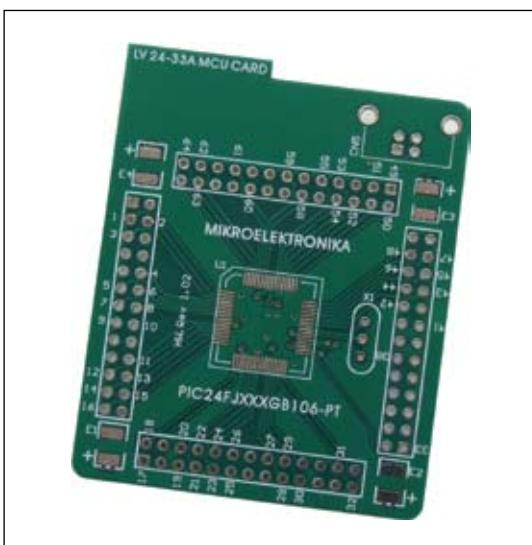
Figura 38: Tarjeta MCU *MCU Card 13* vacía
