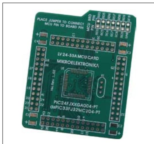
Figura 35: Tarjeta MCU MCU Card 12 vacía
