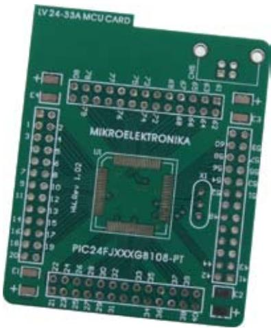
Figura 41: Tarjeta MCU MCU Card 14 vacía
