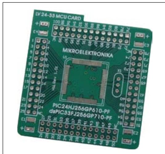
Figura 23: Tarjeta MCU *MCU Card 8* vacía
