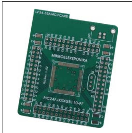
Figura 47: Tarjeta MCU *MCU Card 16* vacía
