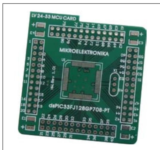
**Figura 11:** Tarjeta MCU *MCU Card 4* vacía
