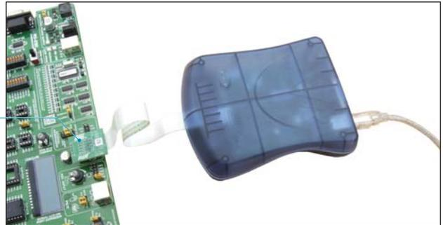
Figure 5-2: *JTAGICE mkII* connecté au système de développement
