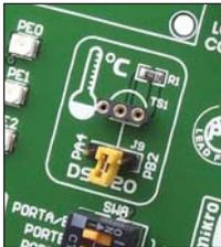
Figure 10-1: la communication 1-wire n'est pas utilisée
