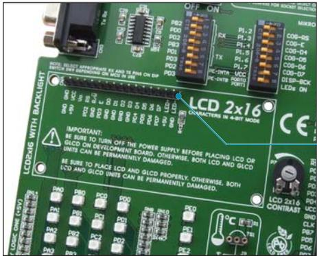
Figure 15-1: Connecteur de l'afficheur LCD alphanumérique
