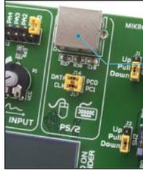
Figure 9-2: Communication PS/2 activée (J16 et J17 sont placés correctement)
