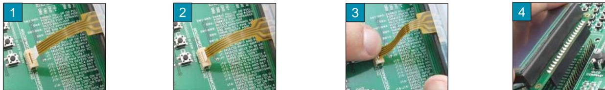
Figure 18-3: Connexion du *touch panel*
