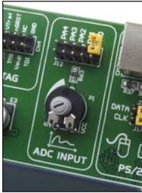
Figure 11-1: ADC (position du  *jumper* par défaut)
