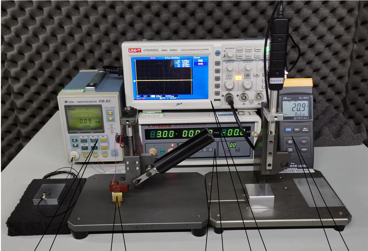
振动量测试仪 Vibration meter 马达安放装置 Test Jig (for Clamping he Motor in Place) 马达综合测试仪 Multi-functional Test Mete 波形脉冲显示 Oscilloscope 噪音测试仪 Noise Test Meter
