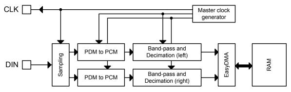
Figure 36: PDM module
